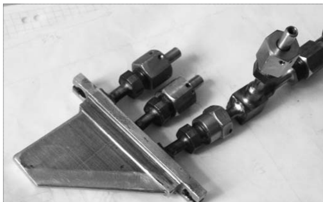
Рис. 7. Топливный пилон ГПВРД с транспирационным охлаждением лидирующей кромки
