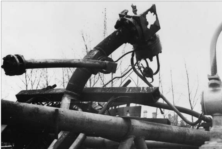
Рис. 1. Общий вид экспериментальной установки после возгорания клапана T268
