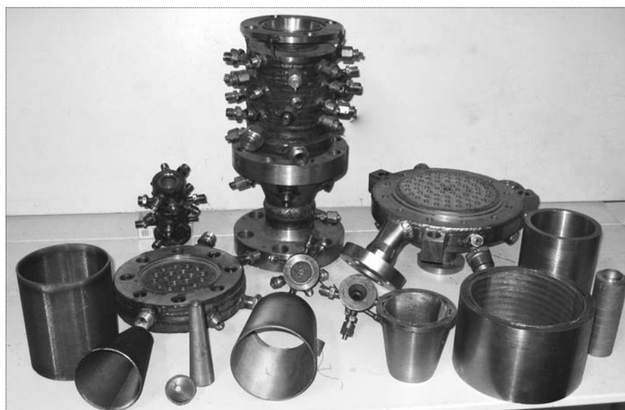
Рис. 1. Элементы камер сгорания ЖРД с транспирационным охлаждением на основе ПСМ из стали 12Х18Н10Т
